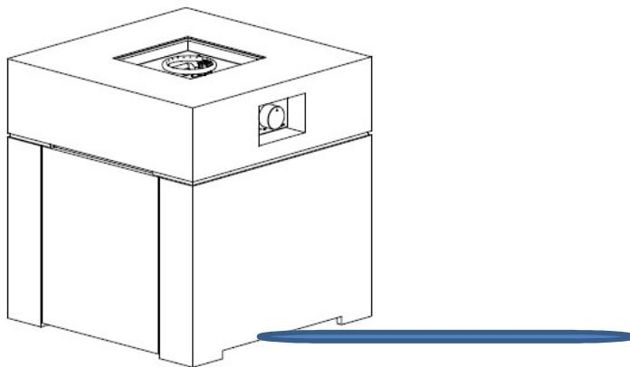
2 . Die mitgelieferte Gasleitung ist 1,5 m lang. Stellen Sie die Gasflasche in einem maximalen Abstand von 1 Meter von der Cosiconcrete. Es ist nicht möglich, die Gasleitung über die Terrasse zu platzieren. Menschen und Haustiere können tatsächlich fallen über diese Gasrohrschnalch. Stellen Sie die Gasflasche dahin, sodass Kinder und Haustieren diese nicht erreichen kann
