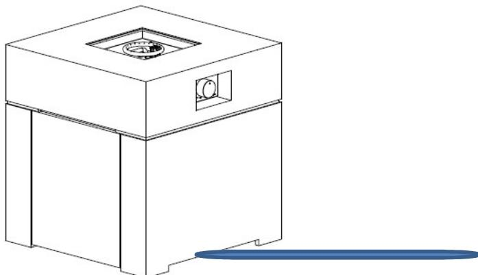
2. De meegeleverde gasslang is 1.5 m lang. Plaats de gasfles dus op een maximale afstand van 1 meter van de Cosiconcrete. Het is niet mogelijk om de gasslang open over het terras te plaatsen. Over de gasslang kunnen personen en huisdieren immers vallen. Plaats de gasfles daarom altijd op een plaats waar niet langs gelopen wordt en waar kinderen en huisdieren niet bij kunnen.
