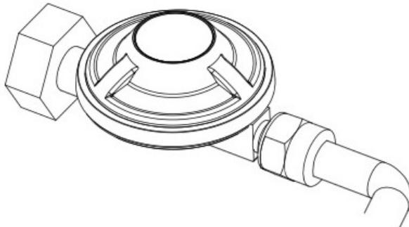
Bei fortbestehenden Problemen, wenden Sie sich an einen qualifizierten Gas -Ingenieur. Ersetzen Sie die Gasleitung oder Druckregler ähnlich wie diese befestigt sind. In den Niederlanden soll ein 30 mbar Druckregler platziert werden. Die Gasleitung darf maximal 2,5 m sein. Im Zweifelsfall bitte berate immer einen qualifizierten Gas -Ingenieur.
