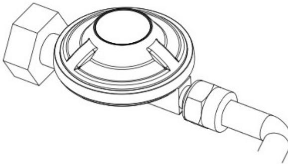
Let er op dat de gasslang altijd naar beneden richting de gasfles wordt gebogen. Zorg ervoor dat de gasslang nooit tegen warme oppervlaktes van het apparaat wordt gedrukt.
