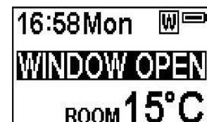
3.2.23 Als de afstandsbediening veel luchtstroom detecteert zal deze de waarschuwing 'raam' open geven. De warmtefunctie wordt dan automatisch ingeschakeld.
