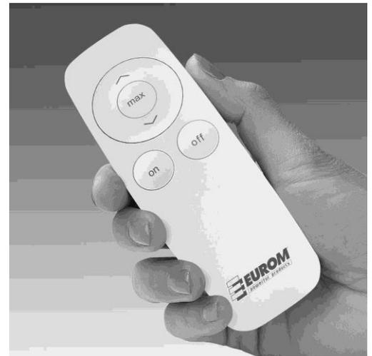
**Výstraha!** Keď vypnete prístroj iba pomocou diaľkového ovládača, zostane v pohotovostnom režime. Preto ho vypnite pomocou diaľkového ovládača alebo vypínača a vytiahnite zástrčku zo zásuvky!
